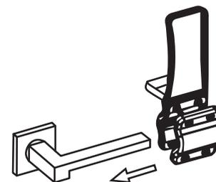
2. Pase los clips del extremo del mango y apriete los tornillos.
