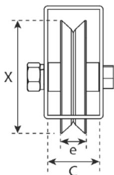
**Importante:** se incluyen 2 golillas planas (arandelas) en caso de utilizar perfil de espesor 2mm. Estas no son necesarias si utiliza perfil de 3mm.
