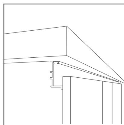
**8. Mueble con esquinas,** es necesario, realizar un corte a 45° en cada esquina para después colocar los conectores decorativos exterior/interior
