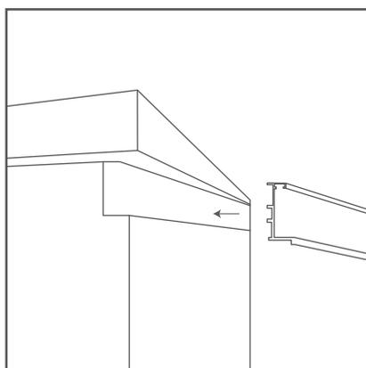
7.- Fijar el perfil al mueble con los soportes en cada uno de los paneles, previamente perforados
