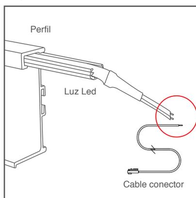
**11.-** Enseguida, conectar el adaptador dependiendo de las entradas y después la fuente de poder a la corriente de luz
