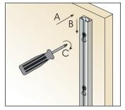
Fijación a pared para la aplicación del perfil a la vista.
