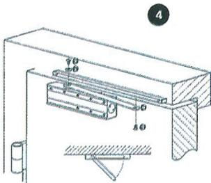
Fijar el brazo ❹ al cuerpo (en la posición que se le indica en el croquis, para permitir la comprensión del muelle). Empujar el brazo hacia la puerta hasta colocarlo paralelo a la corredera. Luego atornillar el brazo a la corredera con el tornillo Allen.
