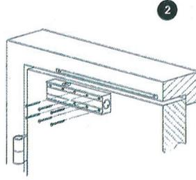
Atornillar el cierrapuertas en su posición (en el montaje estándar, las válvulas de ajuste de velocidad de cierre y de golpe final deberán quedar entre el eje cierrapuertas y la bisagra de la puerta).
