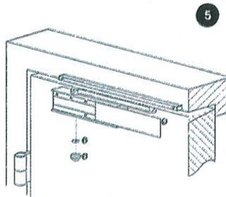
Poner la goma ❶ en el agujero del cuerpo, que haya quedado sin tornillo, para evitar el desplazamiento involuntario de la tapa. Deslizar la tapa ❸ por el carril, para ocultar las válvulas de regulación de los tornillos, y colocar el tapón ❷ embellecedor.
