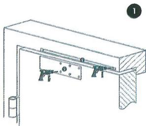
Utilizar la plantilla ❶ (que se adjunta) para marcar los agujeros de sujeción del cierrapuertas y del brazo corredera.
