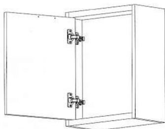
**4** Instale el soporte de montaje en la placa superior del gabinete con la flecha apuntando hacia afuera y fíjelo con tres tornillos. Los parámetros de instalación son los siguientes (o perforar agujeros según el papel de posicionamiento)
