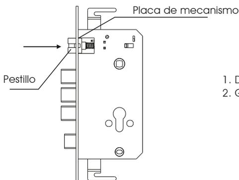
1. Desatornille y retire la placa del mecanismo
